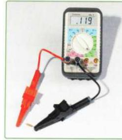
1. Réaliser la mesure **hors-circuit**.
